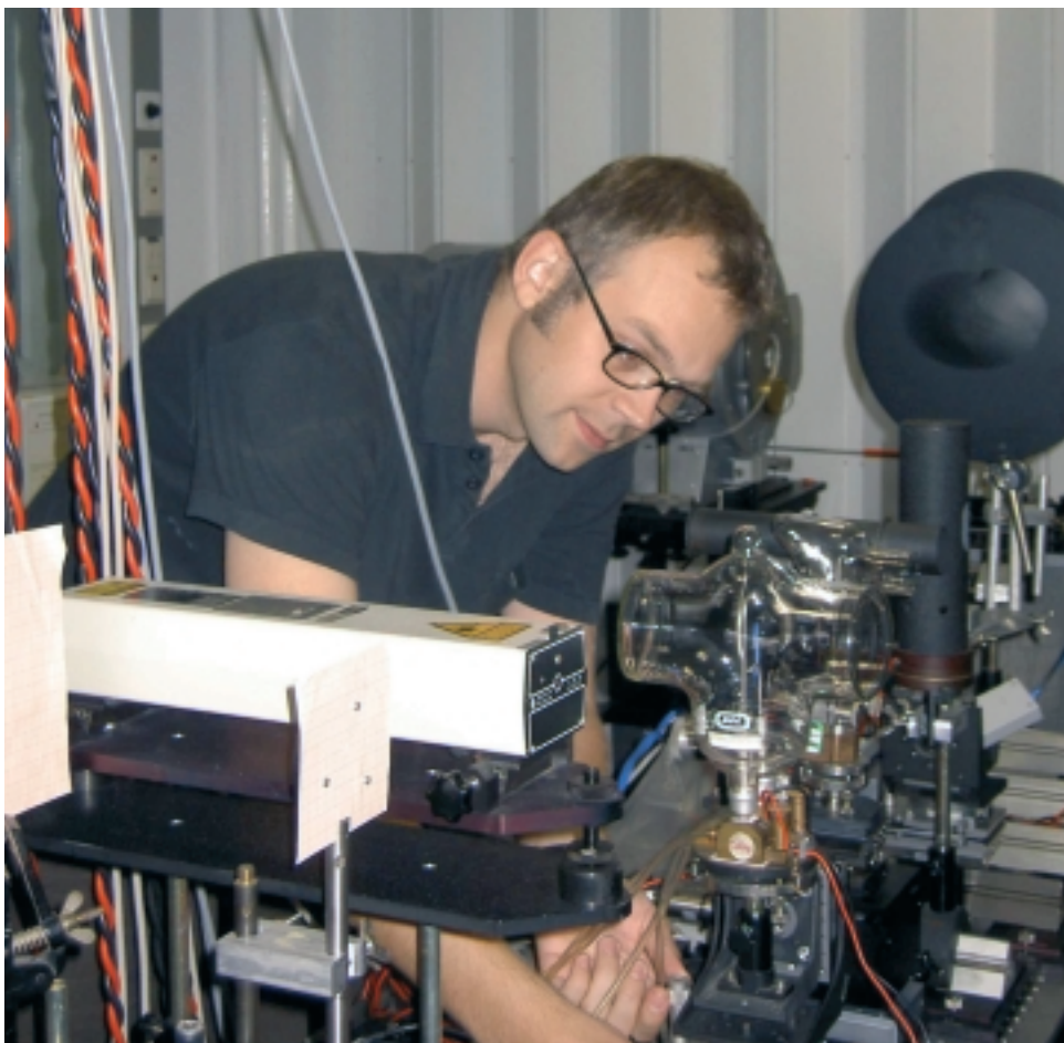
Klaus Anhalt positioniert eine Bandlampe einer Standardlichtquelle für optische Messungen.
