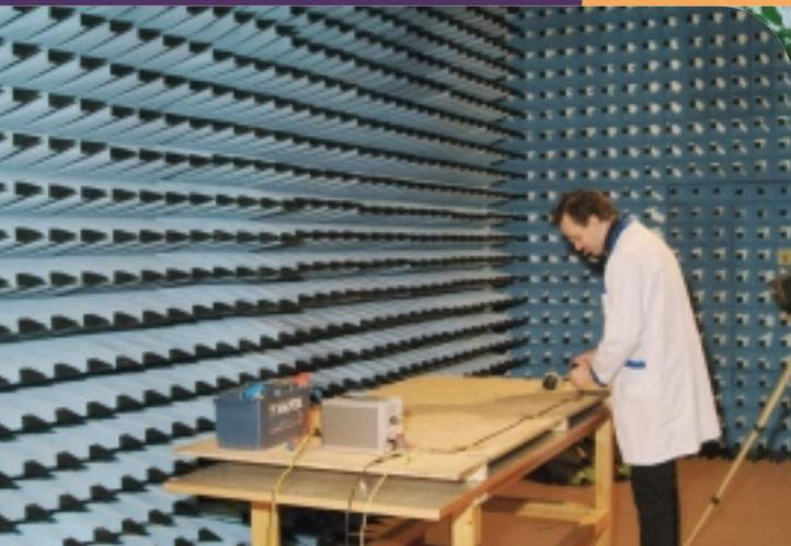
Auch für Versuchsaufbauten sind Elektroingenieure bei Continental Temic zuständig. In der EMV-Halle wird elektromagnetische Verträglichkeit gemessen.
