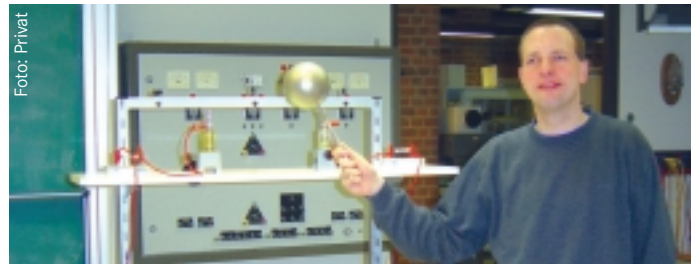
Der Mathe- und Physiklehrer Stephan Armbrust transportiert mit einer isolierten Metallkugel portionsweise elektrische Ladungen. Ein Experiment, das für die 7. und 8. Klasse geeignet ist.
