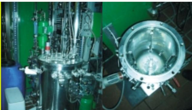
Ein so genannter Bioreaktor stellt eine Umgebung mit optimalen Wachstumsbedingungen für den verwendeten Organismus (zum Beispiel Tierzellen, Hefen, Bakterien) zur Verfügung.
