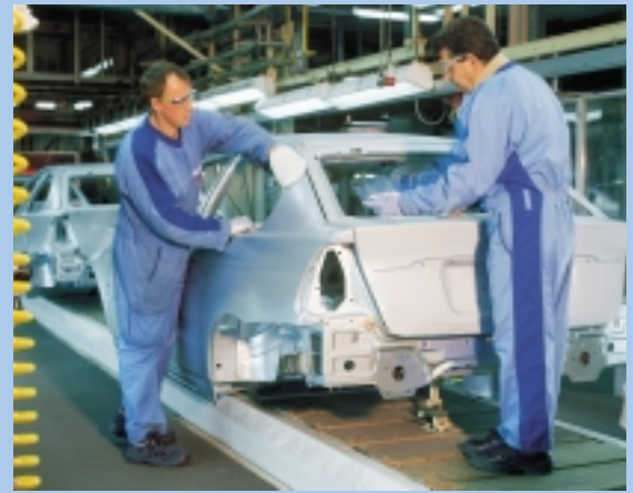
In der automatisierten Fertigungsanlage werden die Karosserien auf Förderbändern transportiert.
