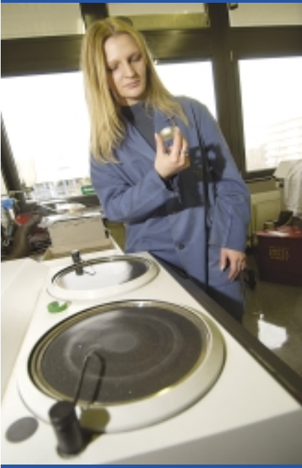
Kleine Kohlenstoff- oder Metallproben werden in einen Kunststoffmantel gebettet und dann auf einer Schleifscheibe im Institut für Werkstoffwissenschaften an der Friedrich-Alexander-Universität bearbeitet.
